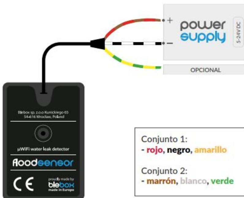
Conexión a otros sistemas de automatización (cortar el cable USB):
